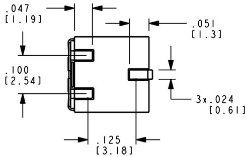
**RECOMMENDED PCB LAYOUT (Inch/mm)**
